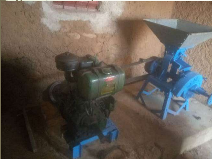
Mise en service et essai du moulin à grains
